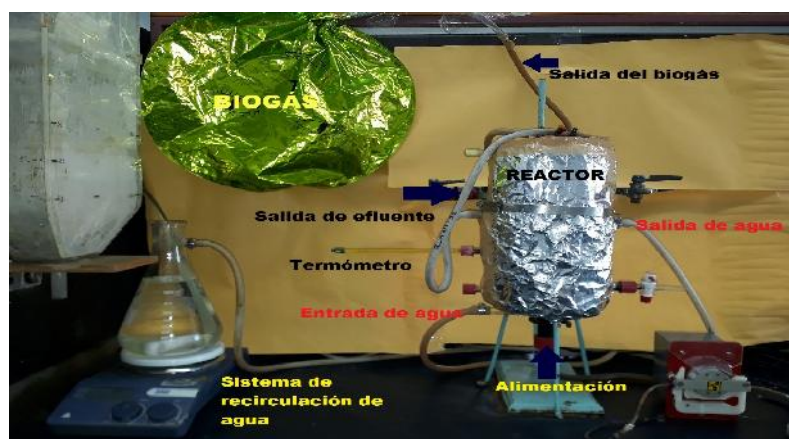
Fig. 1. Sistema completo del reactor anaerobio de lecho de lodos de flujo ascendente (RALLFA) instalado en el laboratorio (en rojo se ven la entrada y salida del agua usada para mantener el reactor isotérmico usando un tanque de almacenamiento del agua recirculada -matraz kitasato-)
