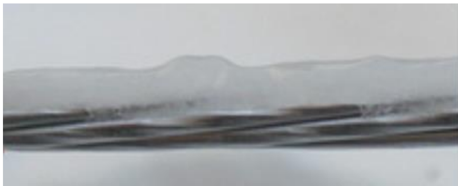
Рис. 2. Провод с супергидрофобным покрытием.
